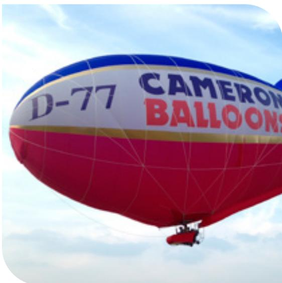
Comme les montgolfières, les dirigeables à air chaud sont d'abord gonflés partiellement avec de l'air froid (température ambiante). Une fois l'enveloppe suffisamment gonflée, un brûleur alimenté par du propane est allumé, et le gonflement se termine grâce à l'air chaud.
