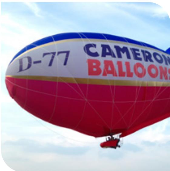
Wie Heißluftballone werden auch Heißluft-Luftschiffe zunächst mit kalter (Umgebungstemperatur) Luft gefüllt. Sobald die Hülle ausreichend gefüllt ist, wird mithilfe eines Propangasbrenners die Luft im Inneren erhitzt.
